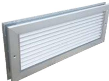
Rešetka „PR“ omogućava strujanje vazduha kroz vrata u pregradne zidove u sistemu ventilacije i klimatizacije. Rešetka je pogodna za ugradnju u vrata i zidove, a u posebnim slučajevima (pomoću štucne) i u zidove većih debljina. Rešetka je izrađena od eloksiranog aluminijuma u prirodnoj boji, a na poseban zahtev može se izraditi u drugim bojama.
